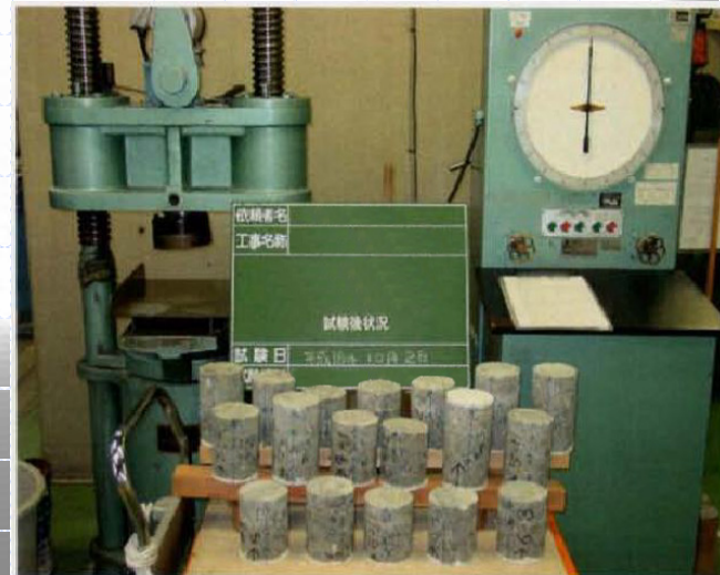
コンクリート強度試験
